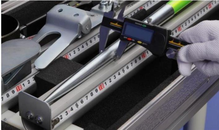
Kaliperom izmjerite **D2** (promjer glave koplja 150 mm od vrha). Točka u kojoj se **D2** treba provjeriti može se lako pronaći pomoću mjerne vrpce instalirane u glavnom segmentu uređaja.
