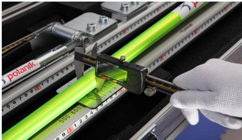
Znamenke na pločici s ljestvicom br. 1 odgovaraju udaljenosti između vrha i graničnika. Kada je udaljenost između vrha i graničnika 2 cm, D5 treba izmjeriti na znamenki 2 na pločici s ljestvicom br. 1.
