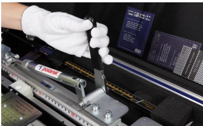
zatim postavite poluge u uspravan položaj tako da mehanizam za stezanje i mehanizam za zatezanje budu u početnoj točki.
