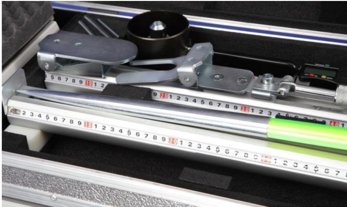
Nakon toga se može očitati **L3** (duljina glave koplja) na istoj ugrađenoj mjernej vrpci.
