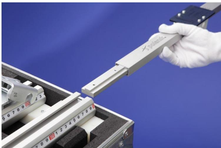
Izvadite segment uređaja s pločicom s mjerilom br. 2 iz kućišta i gurnite, umetnite lijevi kraj segmenta u glavni dio uređaja.
